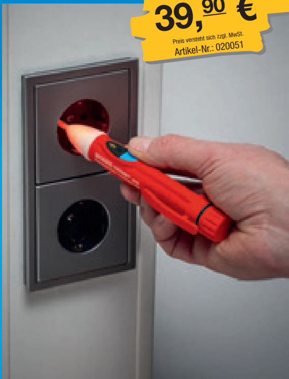
Phasenprüfung an Schutzkontaktsteckdosen und Abzweigdosen.
